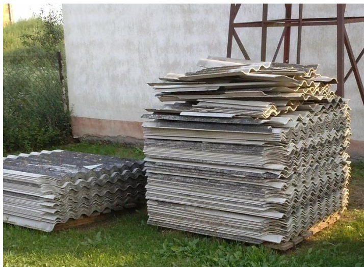
Rysunek 2. Odpady zawierające azbest – zmagazynowane płyty faliste [źródło: materiały własne ]
