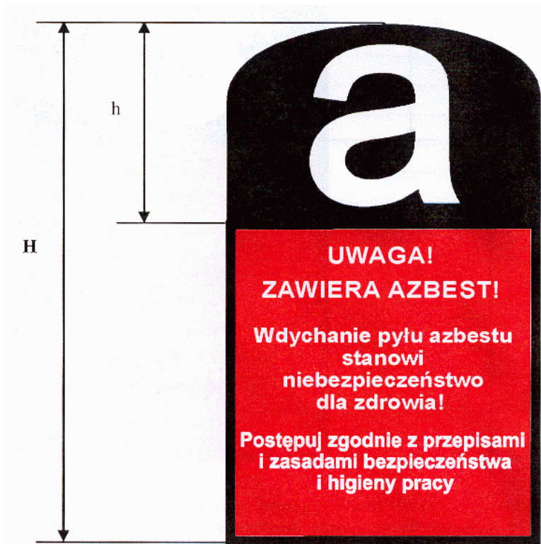
Rysunek 5. Wzór oznakowania dróg utwardzonych odpadami zawierającymi azbest (H = min. 30 cm).
